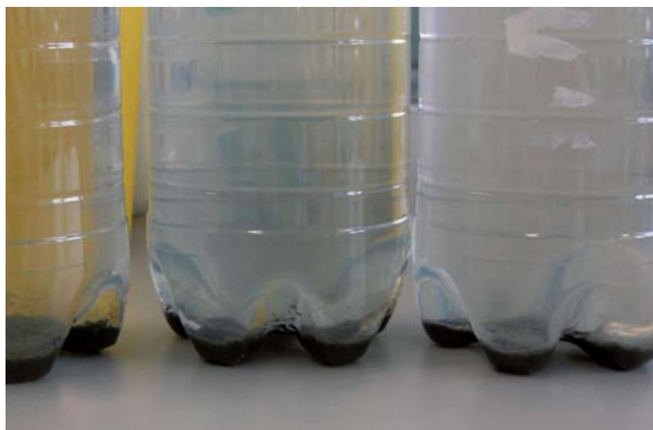
Behandeltes Wasser mit den Samen von Moringa oleifera . Gut zu erkennen ist das abgesunkene Koagulat
